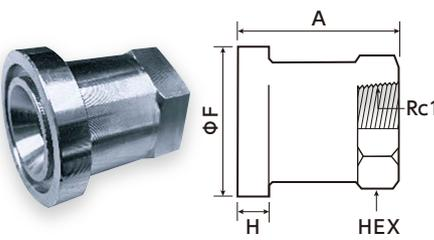
純正品は 4H32×1.5/16UNF の 45° 一体型が標準 (PC200)。本品はメネジ側を Rc とし、既存の 35 や 36 アダプターを使用することでホース接続の汎用性が向上します。
